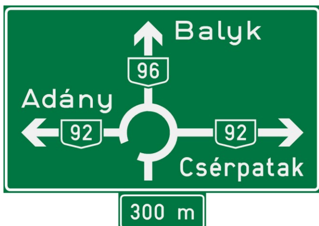
F79. ábra – Egysávos körforgalom előtt elhelyezendő útirány-előjelző tábla típusrajza
