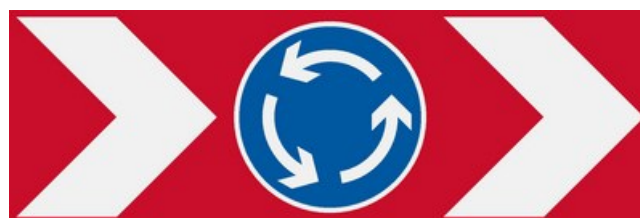
F85. ábra – Irányított áthaladású, többsávos körforgalom középszigetén elhelyezendő iránytábla
