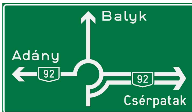
F83. ábra – Spirális és turbó körforgalom előtt, az egysávos belépésnél elhelyezendő útirányjelző tábla típusrajza
