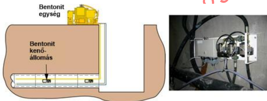
5.10. ábra – Bentonitkenő rendszer kialakítása
