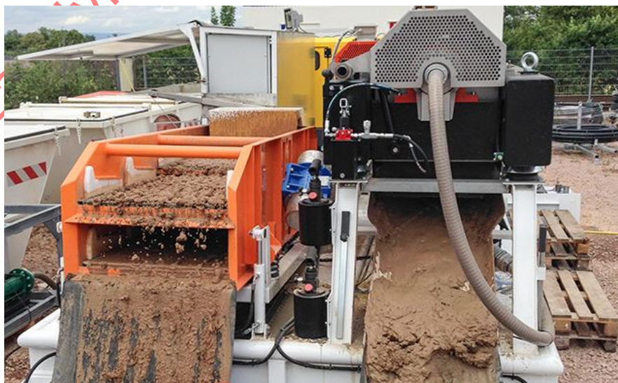
5.25. ábra – HDD-technológia keverőberendezése nagy fúrások esetében
