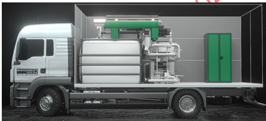
5.24. ábra – HDD-technológia keverőberendezése
