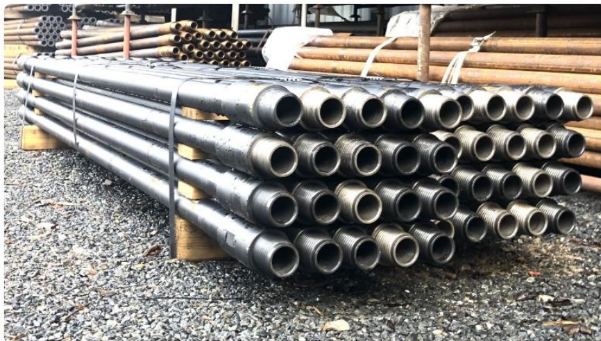
5.26. ábra – HDD-technológia fúrószárjai
